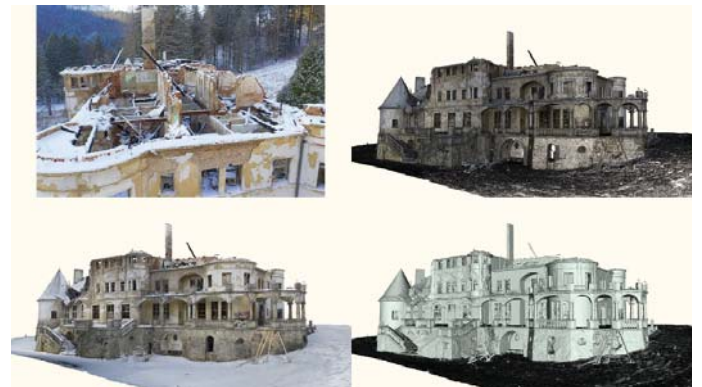
Vygenerovaný 3D model na základe kombinácie laserového skenovania a fotogrametrie s aplikovanou textúrou
