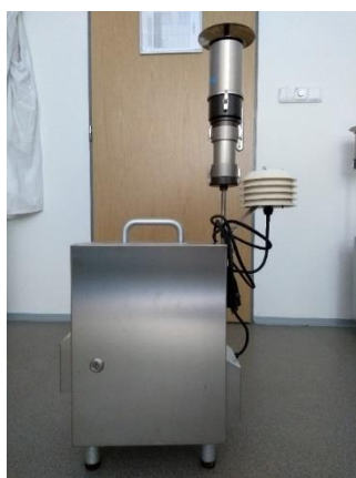
Obr.1 Referenčný vzorkovač tuhých častíc Leckel LVS3
