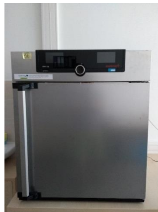
Obr. 3 Klimatická komora Memmert HPP110 procesu stanovenia koncentrácie tuhých častíc nameraných prístrojom Leckel LVS3 podľa normy STN EN 12341
