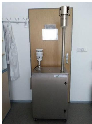
Obr. 2 Kontinuálny optický analyzátor tuhých častíc Fidas 2005 pre kontinuálne meranie tuhých častíc v ovzduší, PM 1 ; PM 2,5 ; PM 4 ; PM 10 ; TSP;
