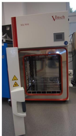
Obr.1 Zariadenie na vytvorenie, reguláciu a meranie prevádzkového prostredia
