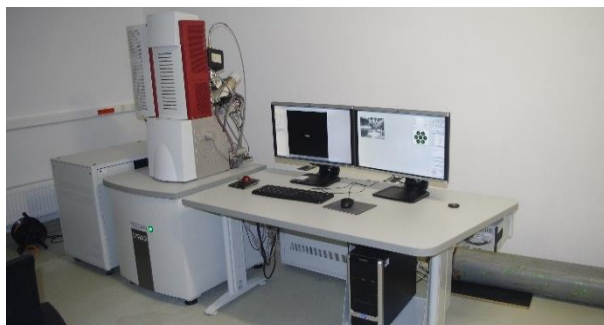
Obr. 2 Elektrónový mikroskop s iónovým lúčom LYRA 3
