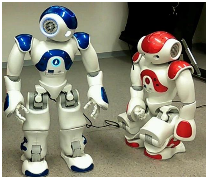
Obr. Softvér na ovládanie robota, popis konštrukcie robota, humanoidné roboty NAO
